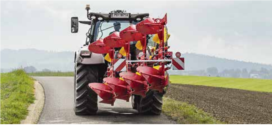
Ist ein Traktor mit Anbaugeräten länger als sechs Meter, müssen an den Anbaugeräten auch längsseitig Rückstrahler angebracht sein PÖTTINGER
